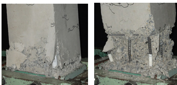
写真-3 荷重履歴 < 8\delta_y \rightarrow -16\delta_y > の -16\delta_y 時の破壊状況 ( s = 120\text{ mm} ：北西面)
