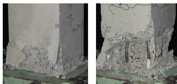
写真-2 荷重履歴 < -8\delta_y \rightarrow 8\delta_y > の 8\delta_y 時の破壊状況 ( s = 120\text{ mm} ：北西面)
