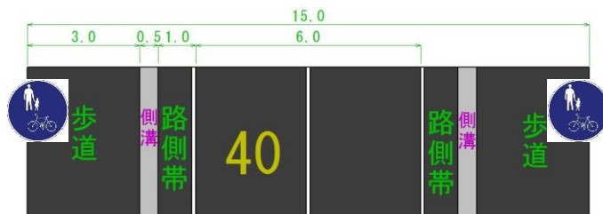
図2 道路構造と幅員の概要図（単位：m）
