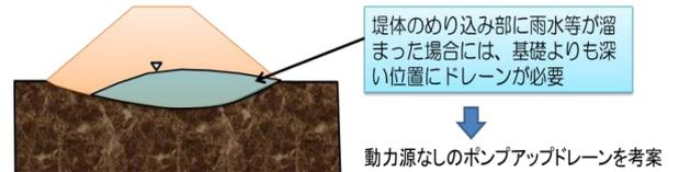
図1 堤体内の閉封飽和域と部分液状化
