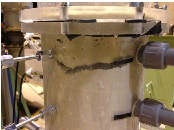
写真-1 間隙空気圧発生による地盤変状(ケース D-3)
