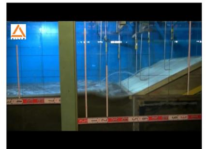
写真-1 水理実験の様子 ( $H_{max} = 0.08$  m; 国総研, 2013)
