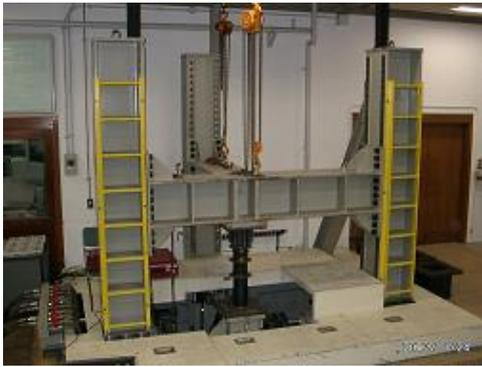
写真-1 三次元構造物試験装置 (京都大学に設置)
