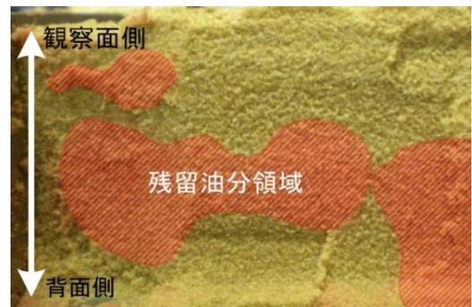
写真-1 土槽内部における浄化ムラ
