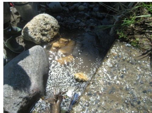
写真2 河川への試験体設置
