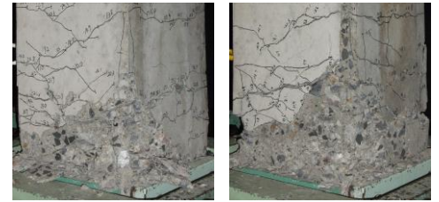
写真-3 矩形載荷履歴 \langle 0 \delta_y \rightarrow -16 \delta_y \rangle の -16 \delta_y 時の破壊状況（北西角）
