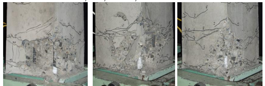
写真-3 載荷履歴 \langle 8\delta_y \sim -16\delta_y \rangle の -16\delta_y での破壊状況 ( s = 120\text{ mm} : 北西面)
