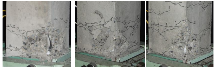
写真-2 載荷履歴 \langle -8\delta_y \rightarrow 8\delta_y \rangle の 8\delta_y での破壊状況 ( s = 120\text{ mm} : 北西面)
