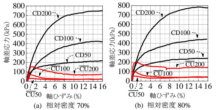
図2 軸差応力～軸ひずみ関係
