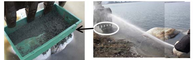
写真-3 天然ゼオライトを含む気水混合高圧ジェット噴流
