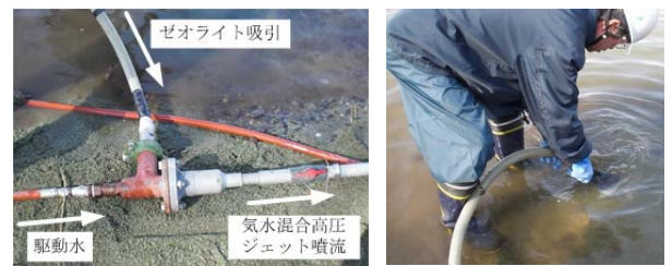
(a)エジェクター本体 (b)天然ゼオライトの吸引 写真-2 エジェクターを用いた天然ゼオライトの洗浄
