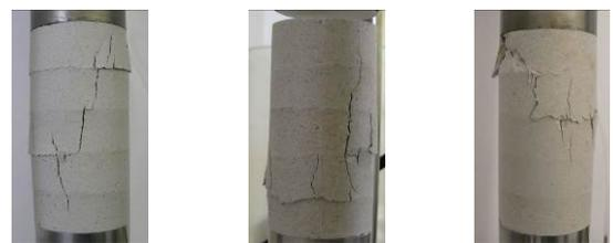
(a)一軸 固化 (7 日) (b)一軸 固化 (14 日) (c)一軸 固化破砕
