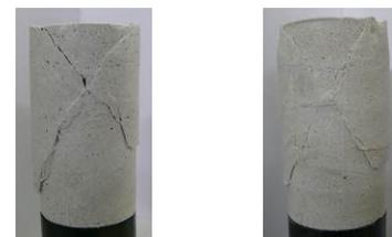
(d)三軸 固化 (7 日) (e)三軸 固化破砕
