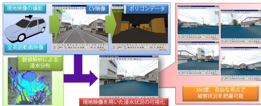
図-4 現地映像を用いた可視化手法の概要
