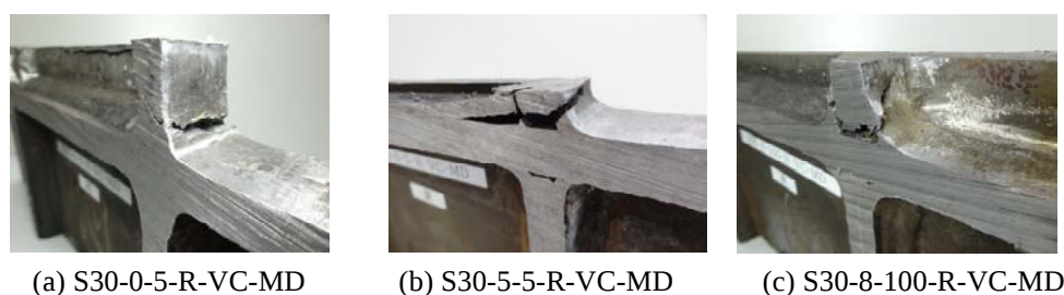
写真-2 十字継手切断断面箇所
