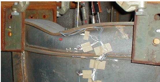
写真1 垂直座屈が発生した試験体
