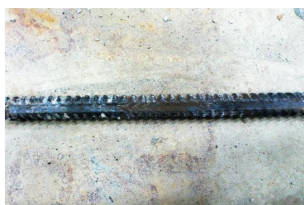
写真-1 F-5 供試体の鉄筋の腐食状態
