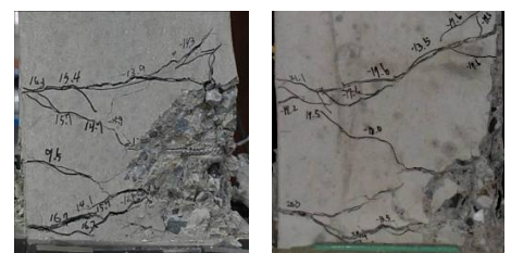
(a) 破壊状況：愛工大 (b) 破壊状況：中部大 写真-4 載荷 < +8\delta_y \rightarrow -8\delta_y > -8\delta_y 時の状況
