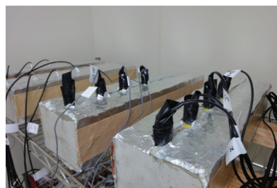
図-2 温湿度センサ用の供試体
