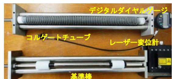
図-2 長さ変化測定装置
