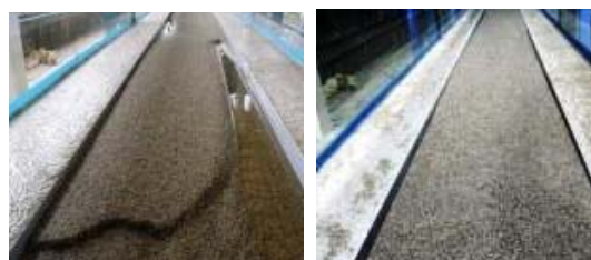
図-5 180l/min における通水前後の水路の様子 (下流から臨む)
