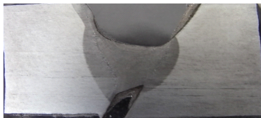
図-4 溶接部横断面のマクロ試験結果
