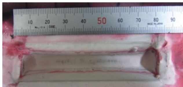
図-3 浸透探傷試験結果
