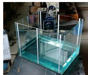
写真-1 アクリル貯槽
