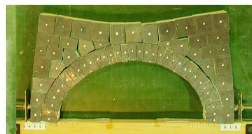
写真-4.1 Type A Case 3 40 mm 緩み時
