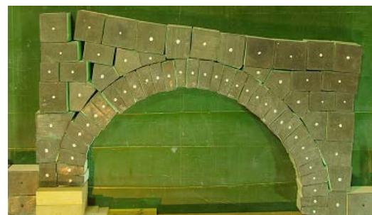
写真-4.2 Type A Case 1 32 mm 沈下
