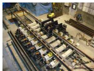
写真-3 軌きょう载荷試験
