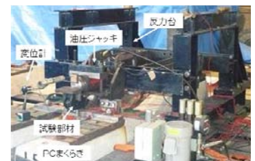
写真-1 水平载荷試験の実施状況
