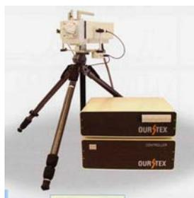
写真-1 ポータブル型蛍光X線分析装置
