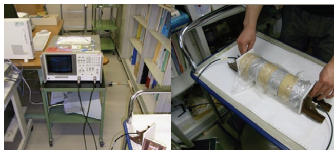
図-2 マイクロ波検査装置(左:アナライザ, 右:測定状況)
