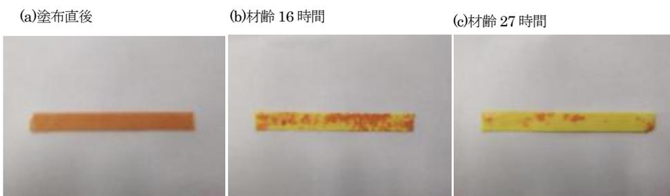
図-1 pH 試験紙の経時変化
