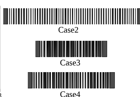
図-7 各 Case の終局時におけるひび割れ性状
