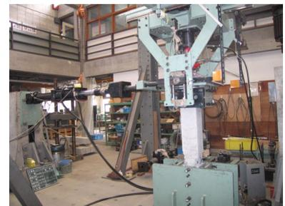
写真-1 载荷実験装置
