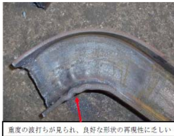
写真-3 H125 半径 200R の波打ちの様子
