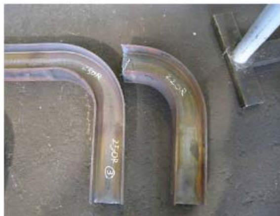
写真-2 曲げ加工後のH型鋼
