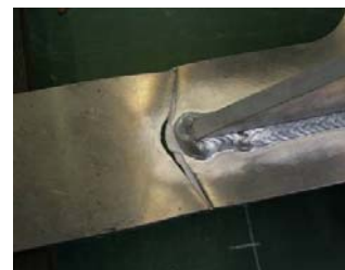
写真-1 破断写真 (素材: A5083P-O)
