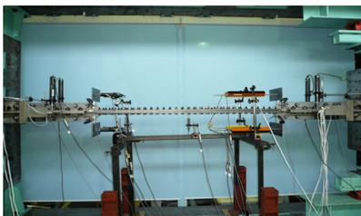
図2 繰り返し载荷実験状況
