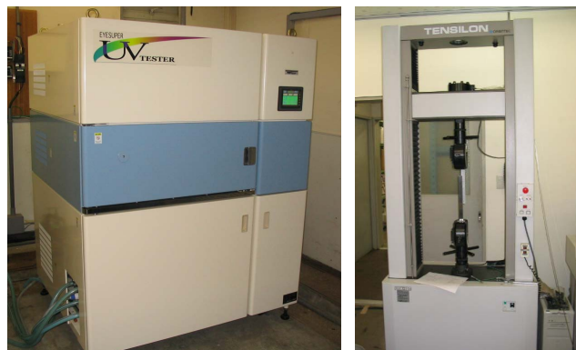
図-1 メタルハライドランプ方式試験機(写真左)と引張試験機(写真右)
