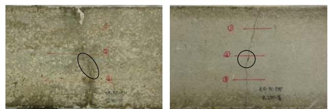
ひび割れ部分の閉塞状況 ひび割れ近傍におけるはく離
