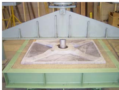
写真-1 試験体の載荷方法
