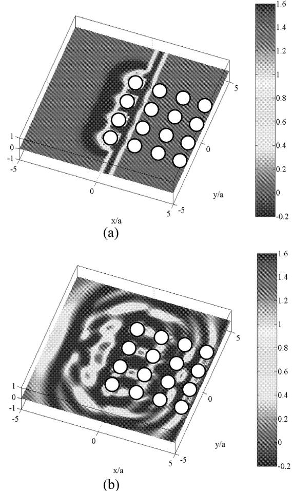
図-3 散乱体周辺の圧力場 (a) :  $ct/a = 1.25$ , (b):  $ct/a = 6.25$
