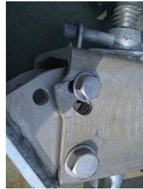
図-2 破壊したジョイント
