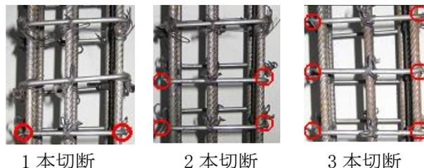
図 2 帯鉄筋の切断状況
