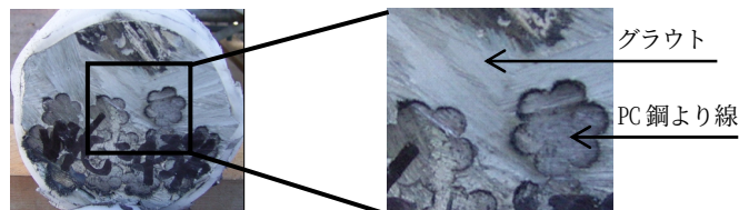
写真-2 グラウトの充填状況 ( W/C=43\% )
