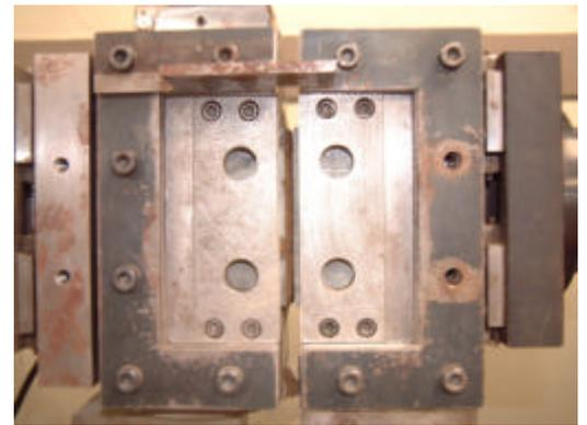
写真-1 石灰スラッジせん断試験の様子
