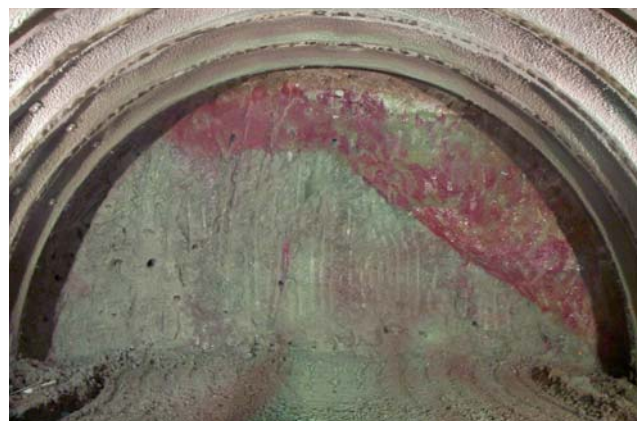
写真-2 置換工状況 (フェノールフタレイン反応)
