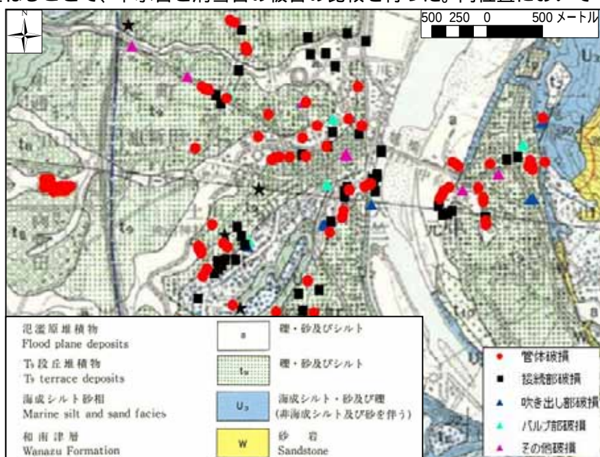
図 1 新潟県小千谷市中心部の消雪管被害と地質分布 2)
