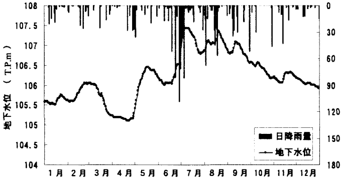
図-2 地下水位変動の一例 (近江富士観測井)
