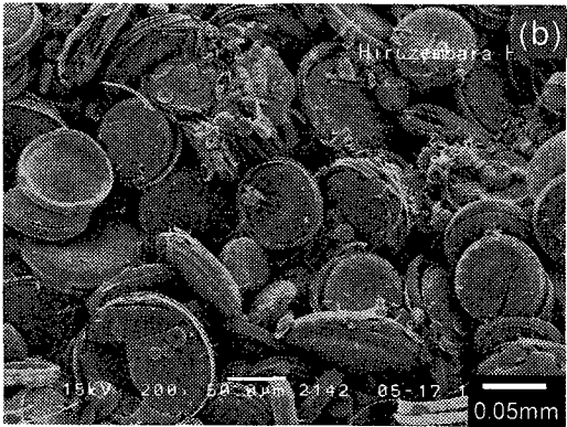
写真-1 蒜山原珪藻土のSEM写真 (a)鉛直断面 (b)水平断面
