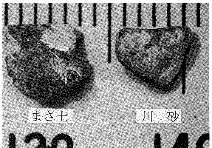
写真-1 まさ土粒子・川砂粒子の比較
