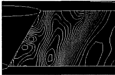
図1 : x-z 平面の円柱後方圧力分布
