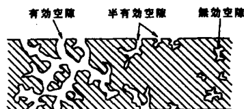
図-3 排水性舗装の空隙の種類
