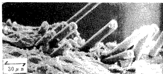
写真2 炭素Aの分散状態のSEM写真 28日 引張り破断面 繊維 0.5%, SF=0%, S/C=0
