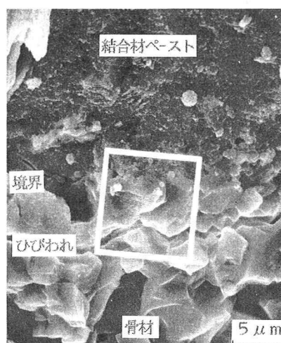
写真3 セメント結合材ペースト-骨材界面のSEM写真。W/C=20%, SF=0% 骨材:石灰岩, 材令28日
